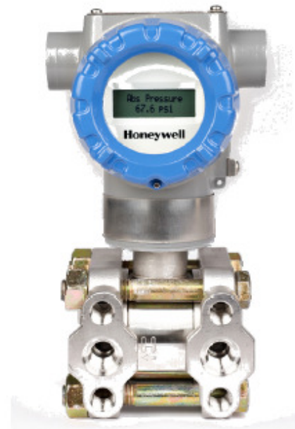
Рисунок 1. В датчиках перепада давления STD700 применяются проверенные на практике пьезорезистивные элементы
